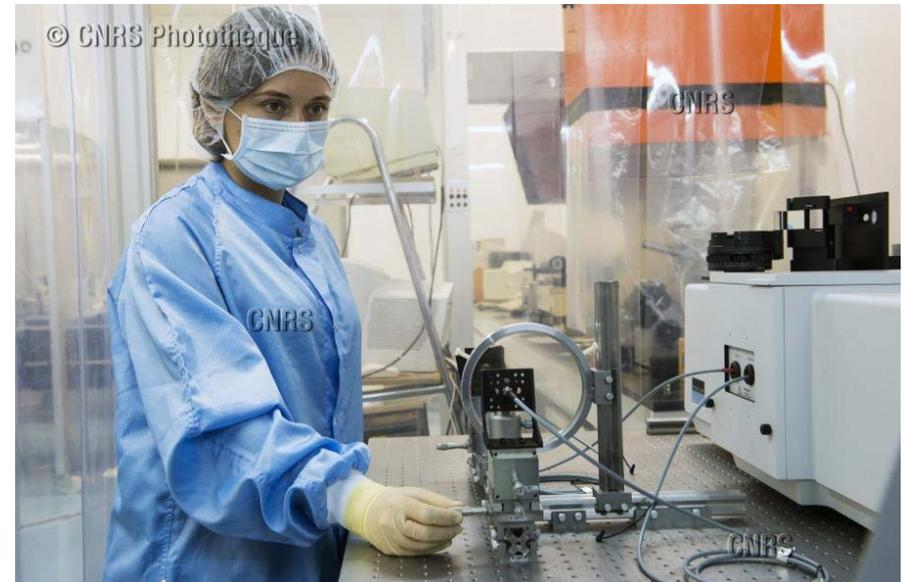
Mesure de l'efficacité de réflexion d'une optique
