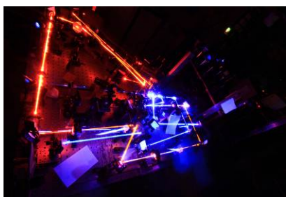
Laser à impulsions ultracourtes (< 20 fs) émettant dans le visible (groupe femto)
